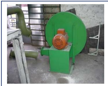
**VENTILADORES TIPO TURBINA A 3500 RPM**
